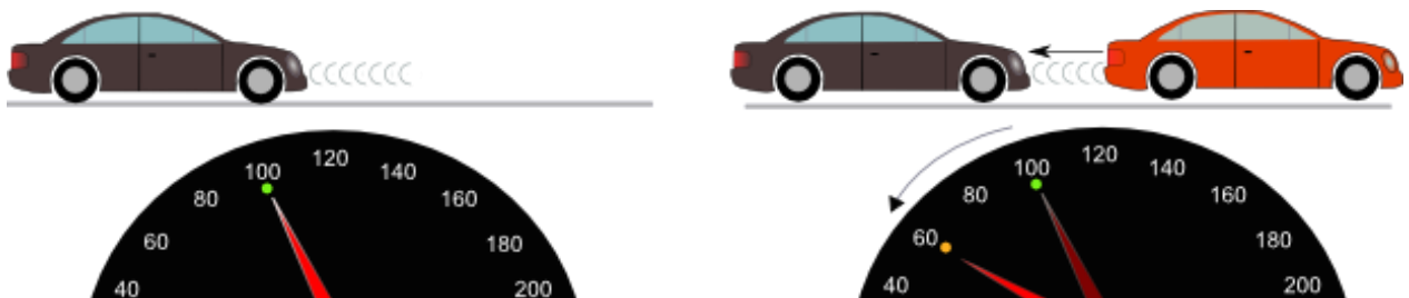
Abb. 1: Schematische Darstellung eines Adaptive Cruise Control System
