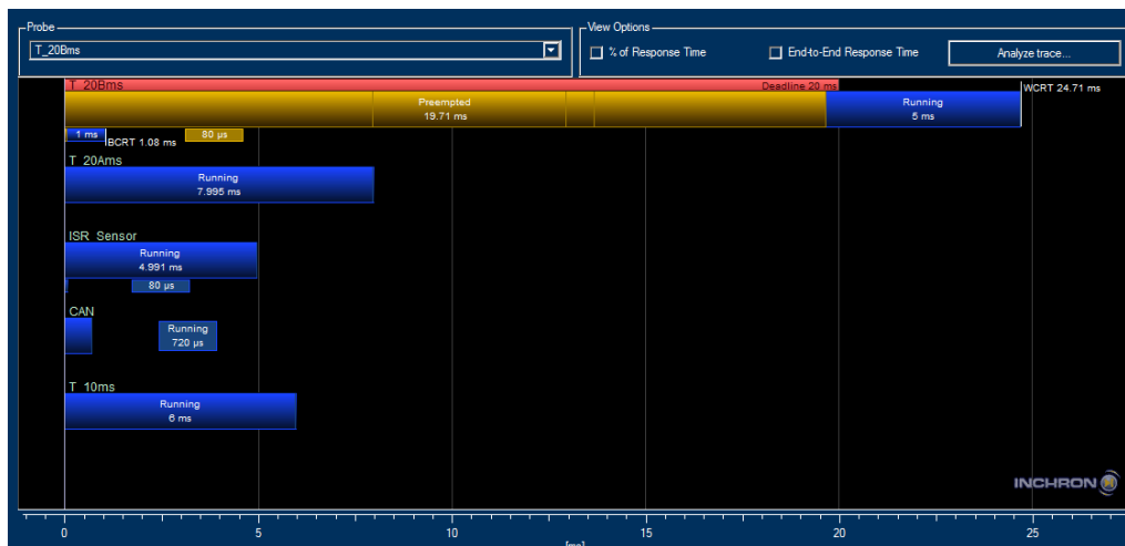
Bild 2. Beispiel für eine Worst-Case-Analyse für ein prioritätenbasiertes Scheduling mit unterbrechbaren Tasks. (Bild: INCHRON)
